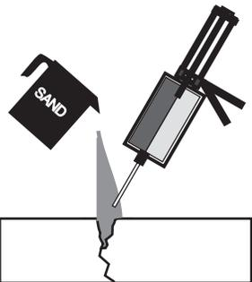
2) Inmediatamente agregue arena de silice y añada 10 Minute Concrete Mender. Añada suficiente producto sobrellenando levemente el arreglo. Use suficiente líquido para SATURAR COMPLETAMENTE LA ARENA.
