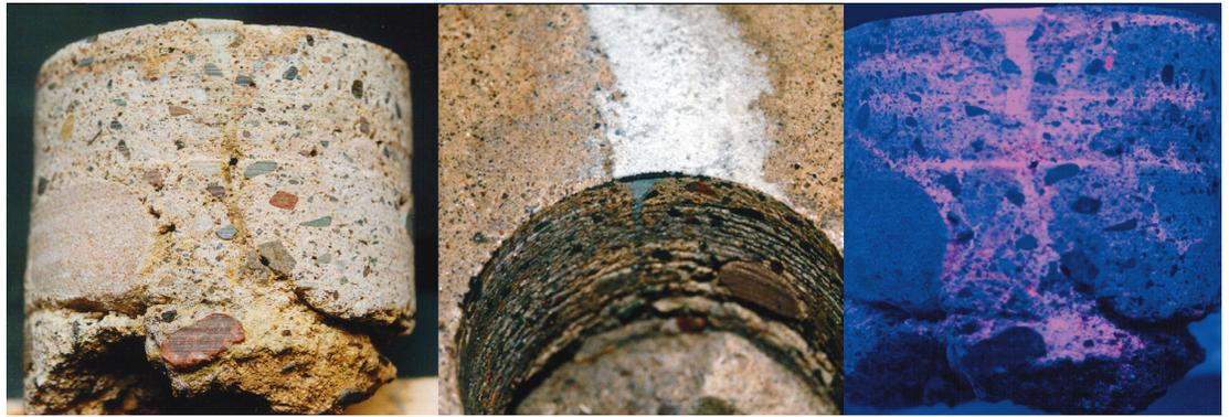
Muestra concreta de la base tomada del concreto reparado con Roadware 10 Minute Concrete Mender. La examinación bajo luz UV filtrada demuestra la penetración profunda y la reparación completa de la profundidad.
