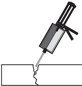
1) Humedezca completamente los lados y el fondo de la grieta con 10 Minute- Concrete Mender.
